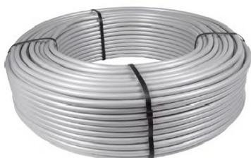
Tubo multicapa ALB gris para climatización radiante, 16x2 mm; compuesto por una capa interior de polietileno PE-RT-I, una capa interna de aluminio soldada a testa, y una capa externa de polietileno PE-RT-I. Presentación en rollos de 200 m ó de 500 m.
